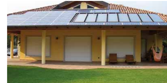
Nord Italia: sistema fotovoltaico integrato connesso alla rete da 10Kwp
